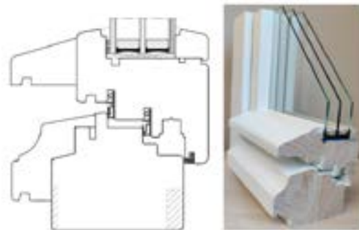
verze 4: k dispozici jsou okapové lišty v systému Energy Concept 90 Třída nepropustnosti vody – 5A (200 Pa)
